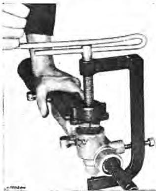
Den Flansch mittels der **Vorspann-Presse Dir. 19** soweit einpressen, bis der **biegsame Arm des Hebels sich am Hebelschraubenkopf anlegt** (Druckkraft : ca. 50 kg). Die Schraube (17) festziehen.
